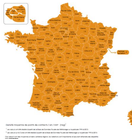
Figure 21 : Carte de la densité de foudroiement de la France issue de la norme NFC 17-102 (05-2015)
